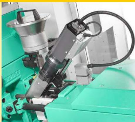
Construction modulaire : le module de micro-moulage garantit une utilisation flexible des machines
