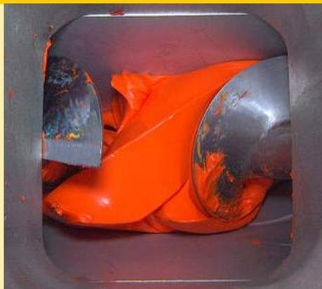
Alimentation des silicones pâteux sans bulles d'air : le dispositif de bourrage INJESTER transforme des blocs « compacts ».
