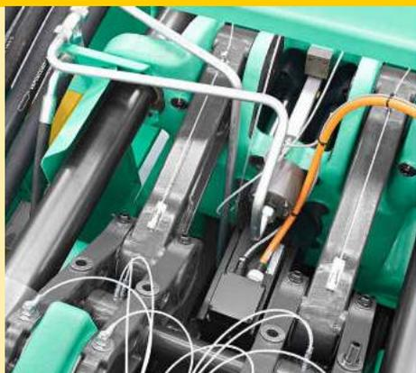
Rapide, précis et à faible consommation d'énergie : unité de fermeture à genouillère servoélectrique.
