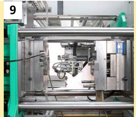
**9** IMD : retrait en douceur des pièces par un système de robot MULTILIFT linéaire.
