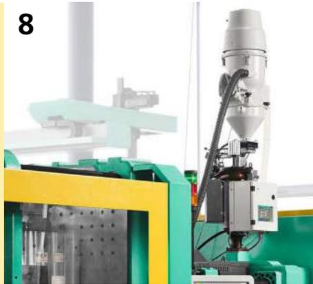
**8** oFoam : alimentation continue de matériau et du fluide porogène.
