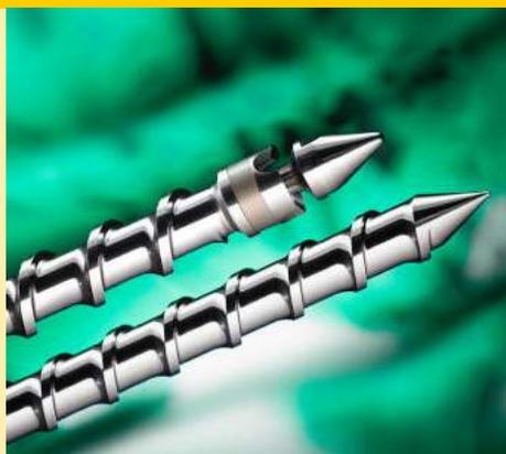
Spécial : vis sans compression avec pas de vis adapté.
